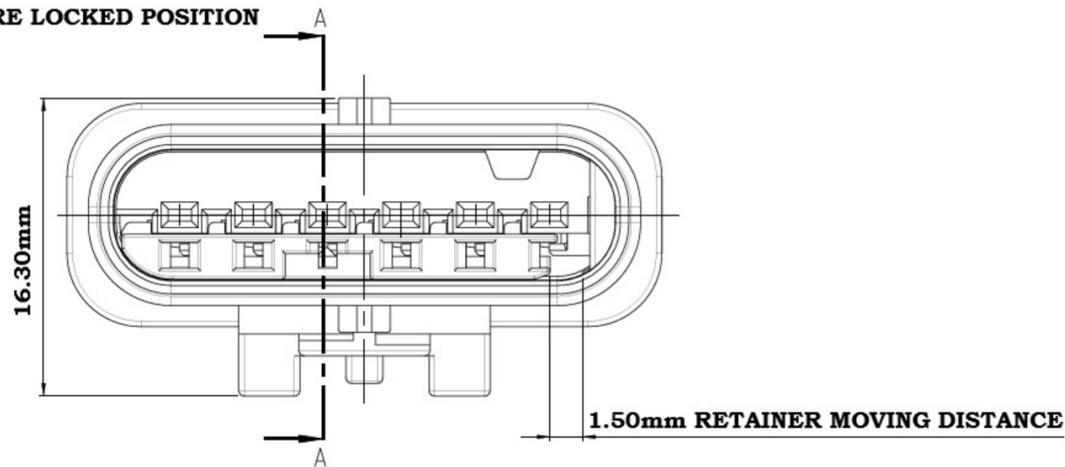
RETAINER IN FINAL LOCKED POSITION
